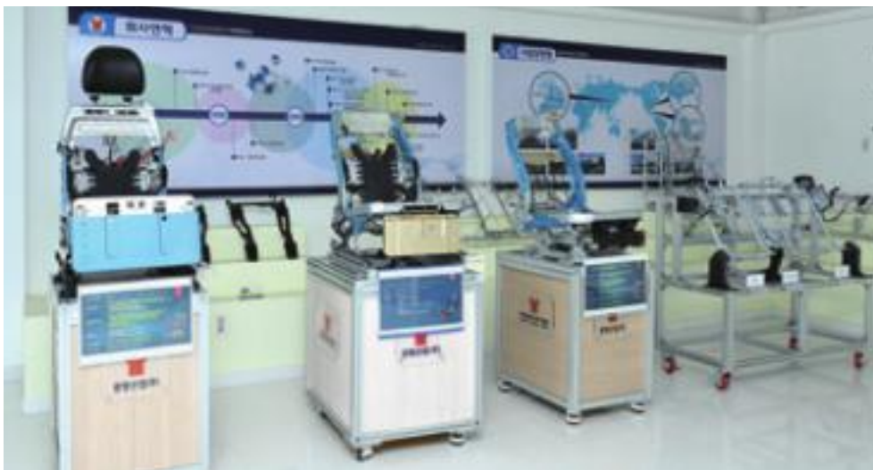
자율주행 시대를 위한 좌석 혁신을 이끄는 광명산업의 시트 프레임 기술. 안전성과 경량화를 동시에 잡은 시트 벨트 일체형 BIS 로테이션 시트 프레임 시제품들이 전시된 모습이다.
