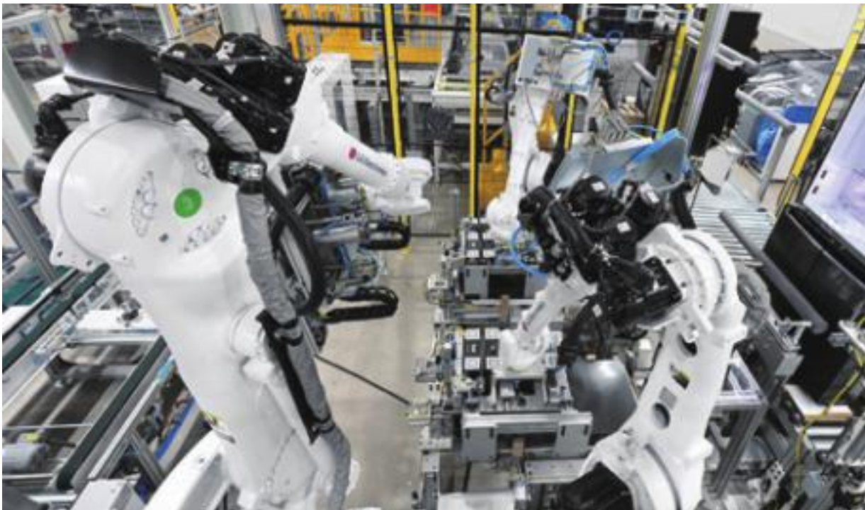
AI를 적용한 LG전자 창원 스마트팩토리. 설비 데이터를 기반으로 품질검사를 수행하며, 고속카메라와 이미지 분석 AI로 외관검사를 실시한다.
