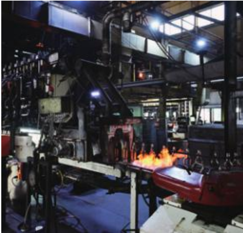
NNPB 공정이 진행되는 금비 생산 라인의 모습. 병의 무게를 줄이고 강도를 높이는 혁신적인 기술은 원료 및 연료 소모를 줄여 친환경 패키징의 새로운 표준을 제시한다.
